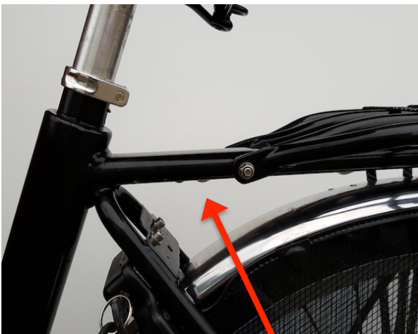
Het frame loopt door in de bagagedrager.
