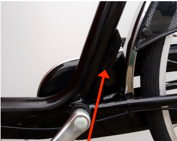
Versteving achterzijde frame.
